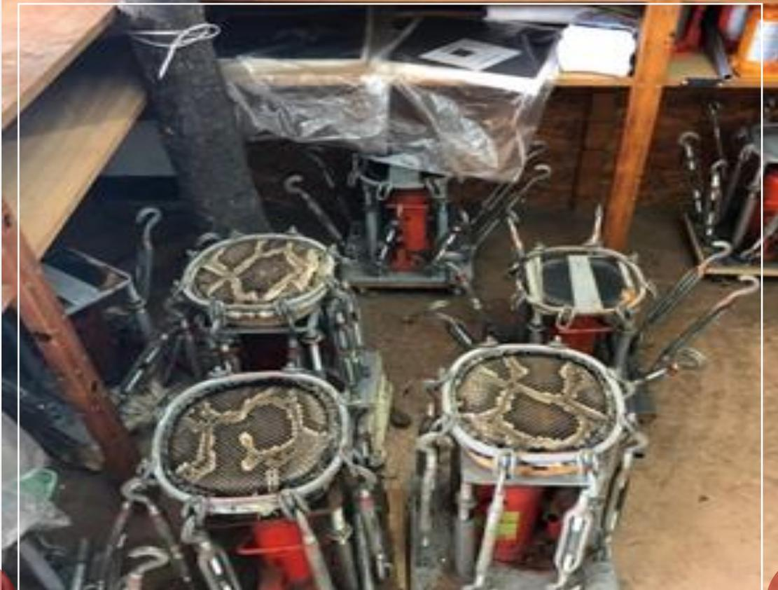
島人工房是一間三線工作室，有教人彈三線、修琴、製琴。其實製琴真的非常不容易，三線的棹（琴桿）及糸巻き（弦軫）都是製琴師用磨的，而照片中是三線的胴（琴筒），工具是為了讓蛇皮能均勻撐開，放置幾天後再將它拆除。此外，三線的品質取決於木材的好壞，蛇皮則一定要夠大張，而我在工作室中所看到的都是已經先處理過曬乾的蛇皮。
